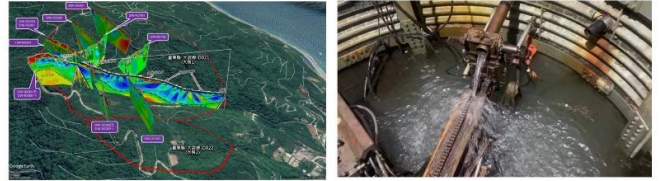
●歷年二維地電阻影像探測成果 ●大口徑集水井出水情形
