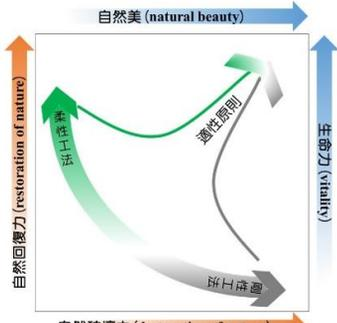
微創工法第一階段為檢傷分級，短期所需之安全穩定性越高，微創適用性越大，在分級策略上以先穩定後友善為主要策略，反之短期所需微創安全性越低則使用災害容受及環境韌性穩定作為策略。本計畫將災害予以分級檢傷並提出相對應之微創處理來擬定相關規範供未來技師參考使用。第二階段對於小規模之破壞或無法立即進行處理之項目，經過勘察找出問題後，以木、竹、石、土結合在大地力，運用傳統智慧進行確保，於後續持續觀察縫補避免傷害擴大，大部分工程在此階段即可結束。對於破壞性較大且需於短期即時加固之工程則進入第三階段輔以適性結構，再回歸第二階段進行地表友善項目，使工程最終對於在地整體生態環境不致產生衝擊，並加速地體自我修復力達成穩定的目標。
