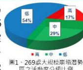
圖1、269處大規模崩塌潛勢區之活動度分級比例
