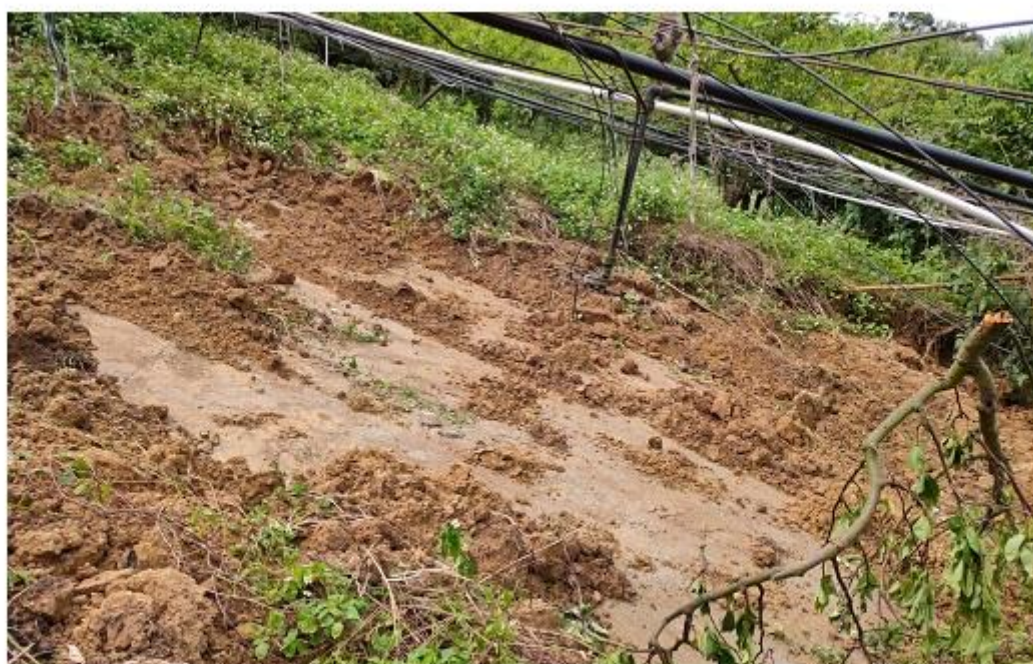
崩場頭部岩盤出露，傾角 19.7^\circ ，崩場土體厚度約 1 \text{ m} (拍攝日期 109/4/8)
