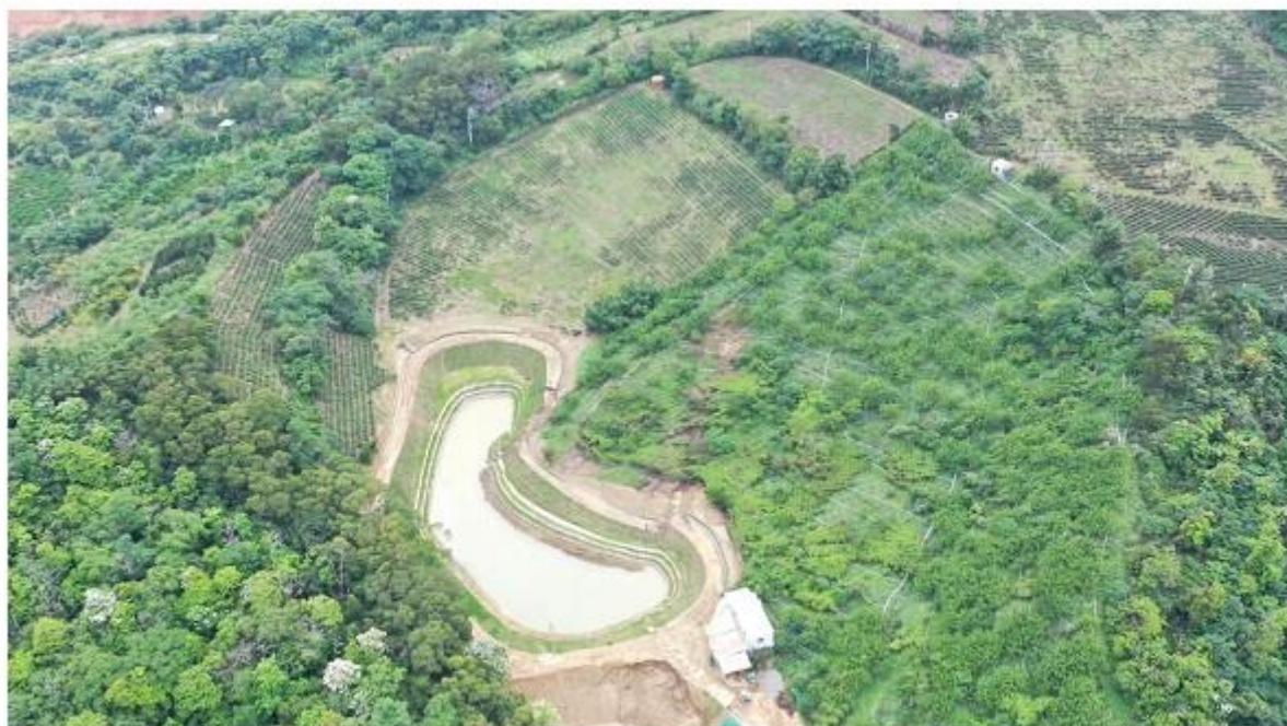
空拍工區相片，崩場面積約 1500 \text{ m}^2 (拍攝日期 109/04/8)
